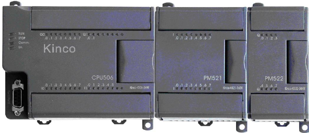
图 10-2 PLC 模块连接后的实际图
