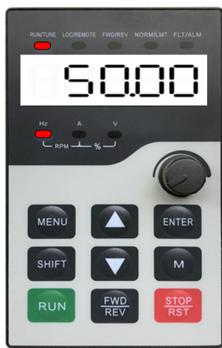
图 4-7 变频器稳定运行显示
