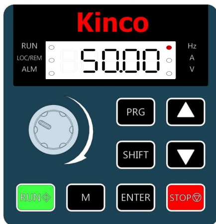
图 4-6 变频器上电显示
