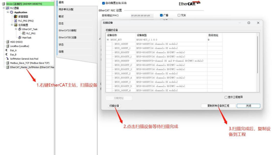
Fig. 9.3-1 通过主站扫描功能识别所挂接的I/O模块
