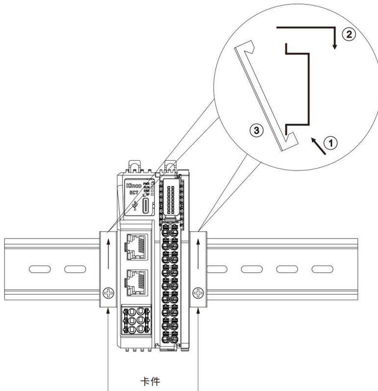
Fig.9.2-5 导轨卡件安装
