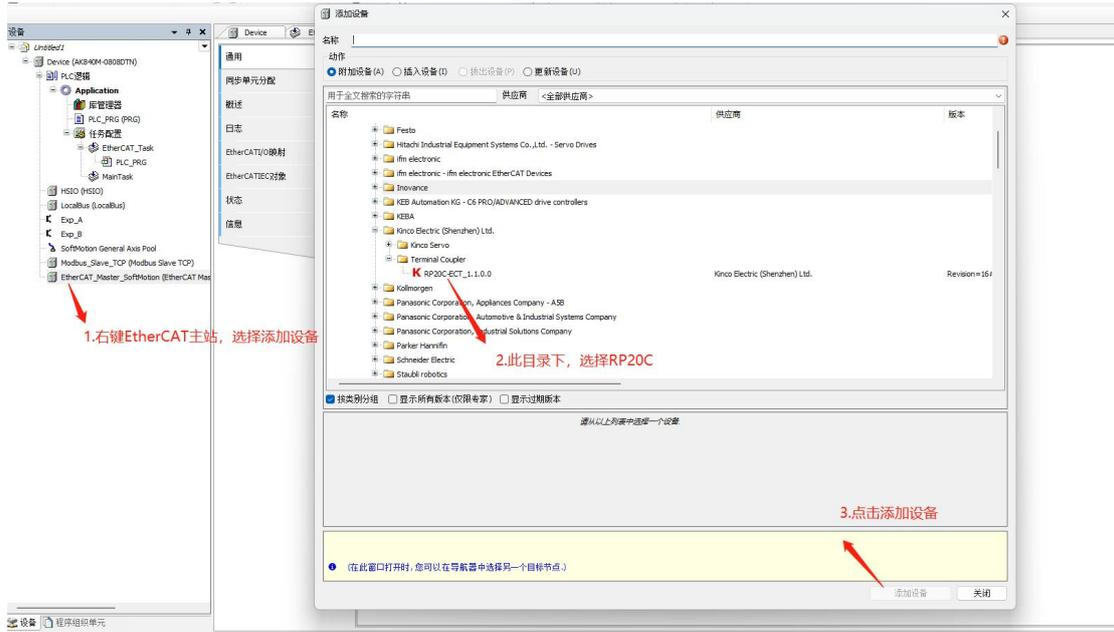
Fig. 10.2.1-6 手动在主站下添加EtherCAT耦合器
