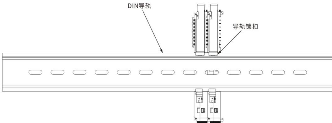
Fig.9.2-4 DIN导轨上连接
