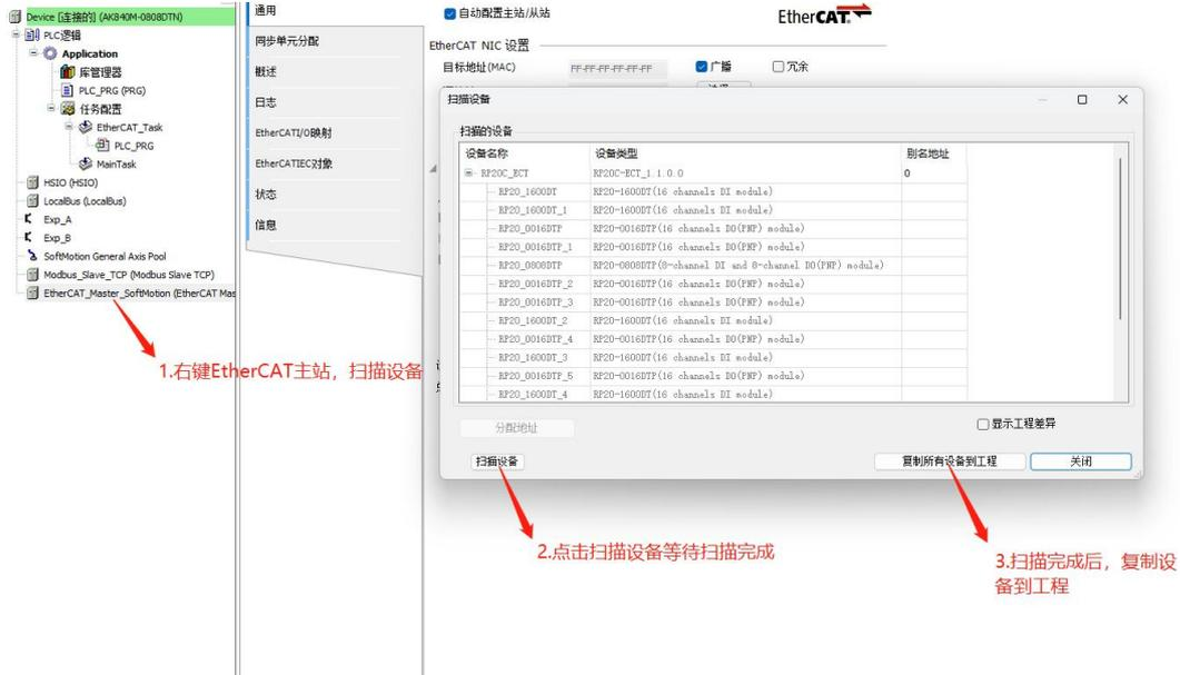
Fig. 10.2.1-4 通过主站扫描功能识别所挂接的I/O模块
