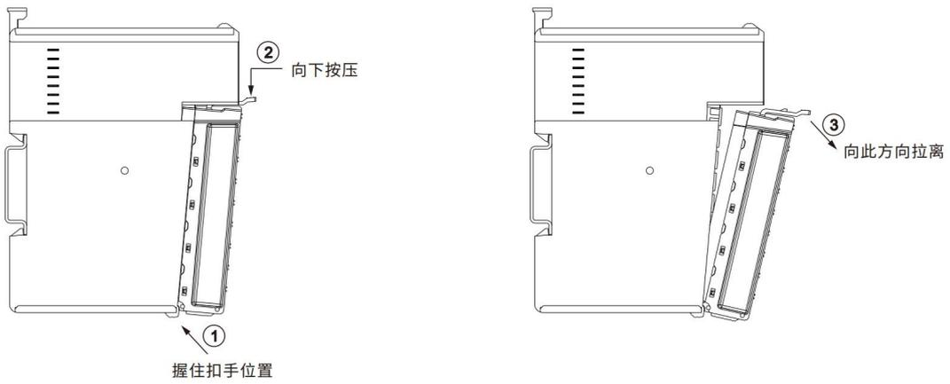
Fig.9.2-8 拆卸端子
