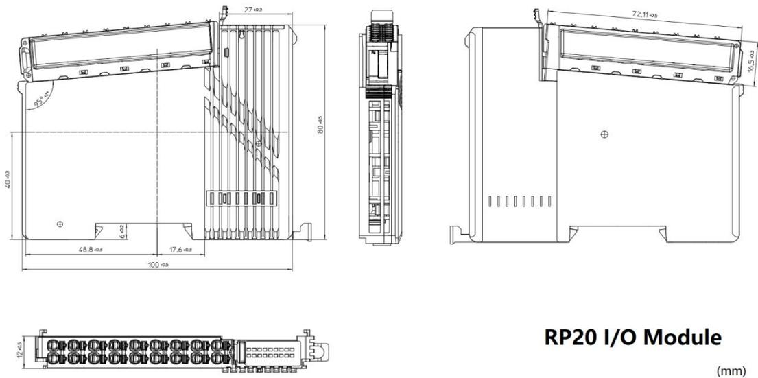
Fig.8.1-1 RP20系列I/O模块尺寸图
