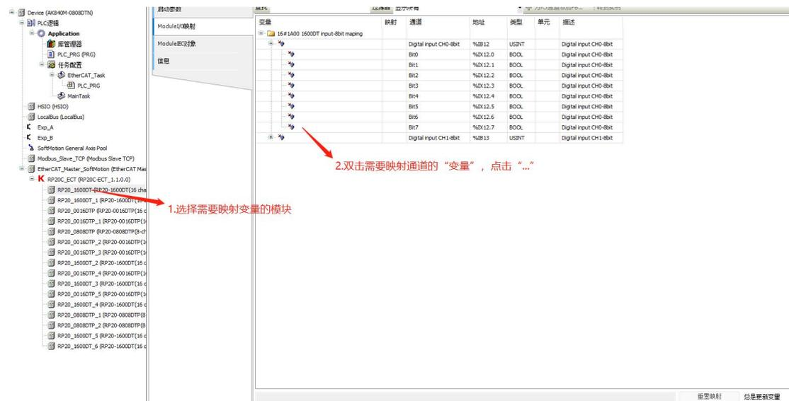
Fig. 10.2.1-11 在“Module I/O映射”界面以Bit形式映射变量
