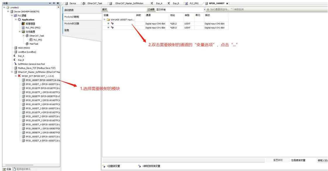
Fig. 10.2.1-10 在“Module I/O映射”界面以Byte形式映射变量
