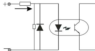
**注意：** 本驱动器的所有控制信号的输入电路中都采用了可靠的光耦元件进行隔离，可以减少外部电气噪声对于本驱动器的干扰；所有的控制信号输入端口可直接采用5~24VDC电压的控制信号控制。
