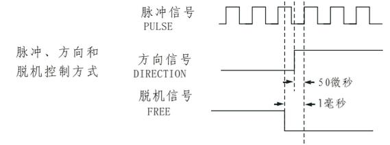
**注意：** 本驱动器只能工作在脉冲和方向控制方式；当输入脉冲信号时，电机会按照初始的方向旋转（初始方向和电机的接线有关，互换两相可以改变电机初始运行方向），当改变方向信号的电平时，电机就会按初始方向的反方向旋转。
