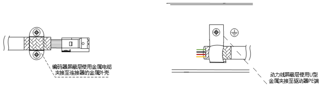
图 3-16 FD1X5 驱动器侧动力线/编码器线屏蔽层 1*处理方式
