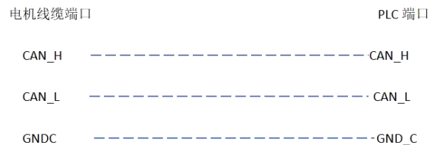
图 3-6 CAN 通讯管脚及接线图
