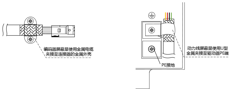
图 3-7 驱动器侧动力线/编码器线屏蔽层 1*处理方式
