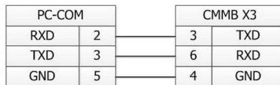
图 9-3 电脑 DSub 9 针串口头和驱动器 X3 接口接线图
