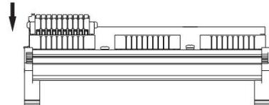
图 4.3-01: 端子排安装步骤
