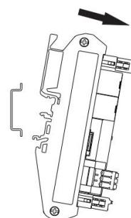
图 4.2-03: 产品拆卸步骤
