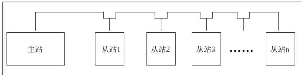
图 5.4-01: 一般总线拓扑结构
