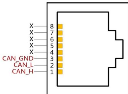
图 5.4-02：CANopen 通讯引脚定义（RJ45）
