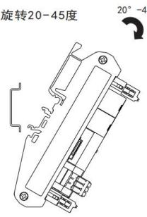
4. 将产品如图卡到导轨下侧中
