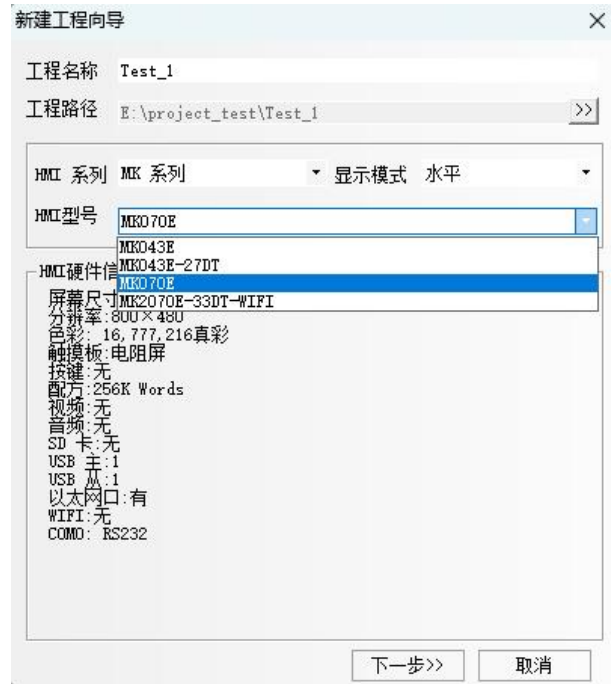
图 5.1-9 选择 HMI 型号，这里以 MK070E 为例 设置好后点击[下一步>>]按钮，完成工程创建。
