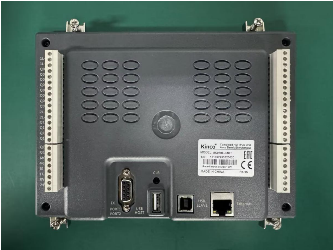
图 3.3-8 将固定配件安装至上、下两侧
