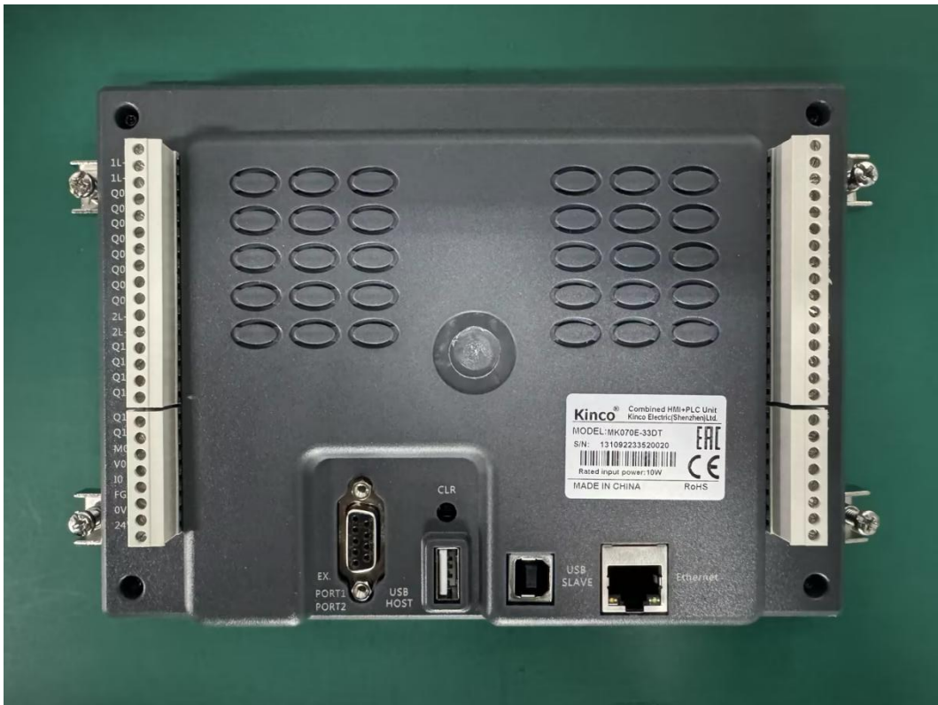
图 3.3-9 将固定配件安装至左、右两侧
