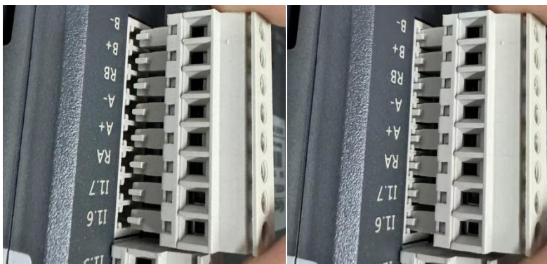
图 3.3-3: 端子安装步骤示意 1
