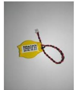
图 2.2-9 RTC 电池实物
