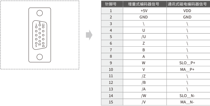
电机编码器输入接口 X4
